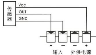
③ 单相 2 线制 4mA~20mA 电流脉冲传感器或无源开关
