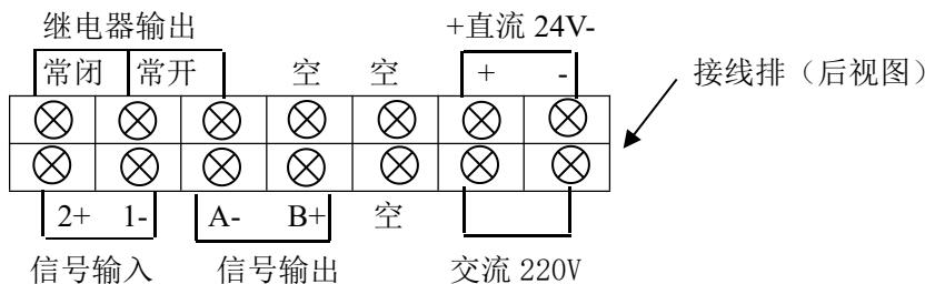
注：接线时注意信号的正负极，供电电源只能接其中一种（建议使用直流 24V）。
