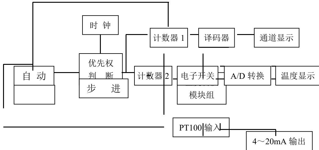
当温度变化时，PT100 传感器阻值随着变化，该信号通过温度电压转换模块变成电信号，一路经电子开关选择后送到 A/D 转换器，再到温度显示器，另一路经 V/I 转换后，实现 4~20mA 输出。
