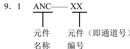
例：ANC—01 表示第 1 通道的 PT100 电压、电流、报警转换模块。
