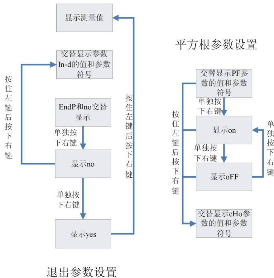
图 2：左边图解说明如何退出参数设置及误进入退出选项后如何回到参数设置，右边图解说明如何进行 PF 参数的设置。
