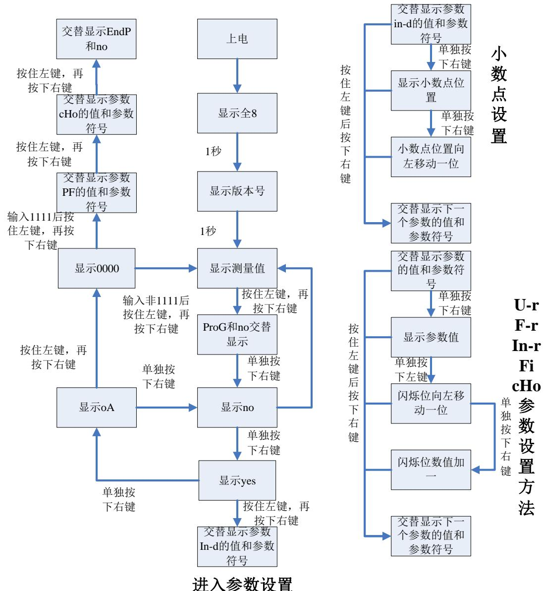
图 1：左边图解说明如何从测量状态进入参数设置状态及误进入后如何退出，右边图解说明 U-r, F-r 等参数为数字的参数的设置方法。
