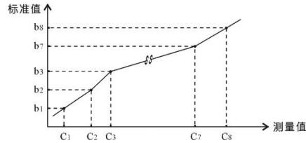
★ 小于 C1 的测量值，仪表按后一段的数据向下递推；大于 C8 的测量值，仪表按前一段的数据向上递推。
