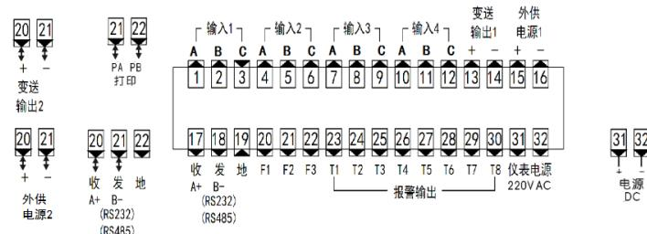
上图中，报警输出 T1~T8 每两个端子表示一组继电器输出，最多可输出 4 个继电器。
