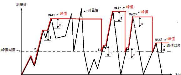
如上图所示，自动判断峰值：重新上电当测量值首次超过峰值阀值设定值（图中 T1）后，仪表开始检测峰值；当测量值回落幅度超过峰值回差设定值（图中 B = 峰值回差设定值）后，仪表完成峰值检测。获取到峰值 MAX1，峰值锁定。波峰再次上升不再判断峰值。
